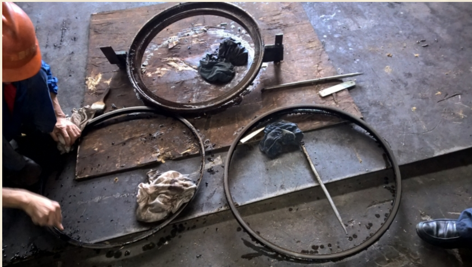
G型滑环式密封磨损严重
