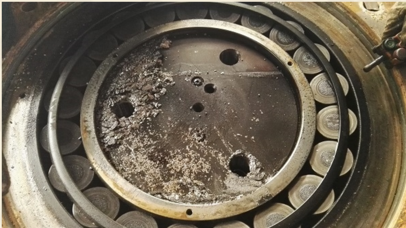
磨辊腔内有大量的铁屑、铜屑
