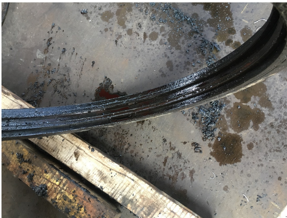
b) 外侧端盖磨损严重螺栓沉孔已磨平，压盖螺栓断裂，磨损严重需要更换
