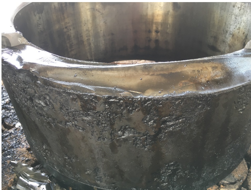
b) F564445 轴承内圈剥落掉块
